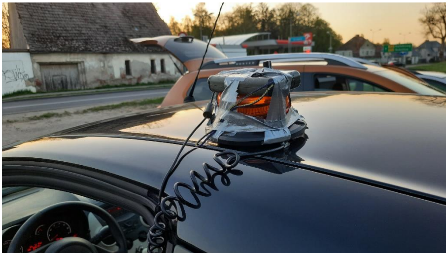
Fot. 23. Montaż detektora na dachu przed nocnymi transektami.
